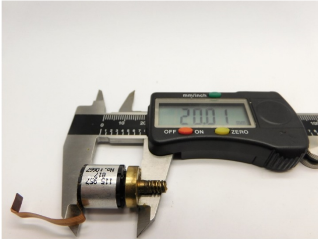
Maße prüfen Check dimensions Controleer de maatvoering
