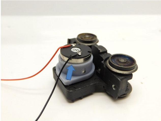
Der Motor wird mit Epoxidkleber oder Sekundenkleber in den Motorhalter eingeklebt The motor is glued into the motor holder with epoxy glue or super glue De motor wordt in de motorhouder verlijmd met secondelijm of epoxy lijm
