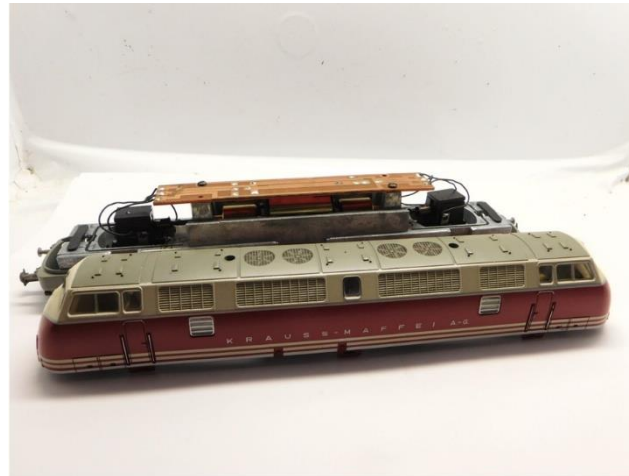
Gehäuse entfernen Remove housing Verwijder de kap
