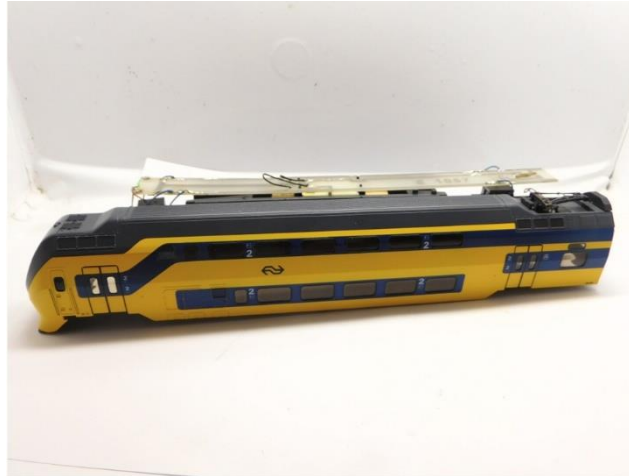
Gehäuse entfernen Remove housing Verwijder de kap
