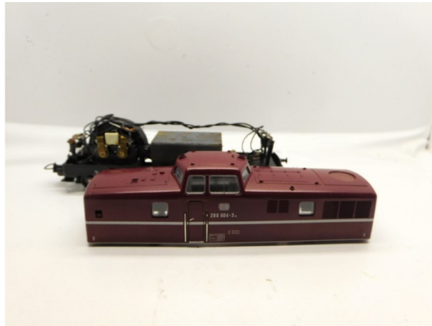
Gehäuse entfernen Remove housing Verwijder de kap
