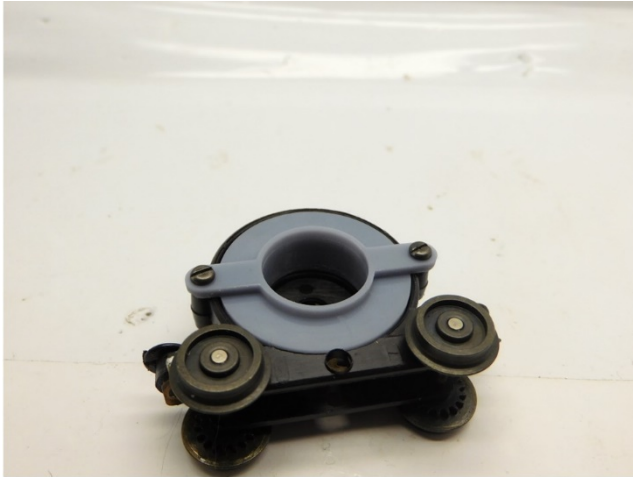
Motorhalter platzieren Place motor holder Plaats de motor houder
