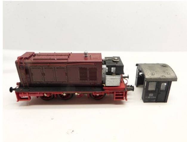
Gehäuse entfernen Remove housing Verwijder de kap
