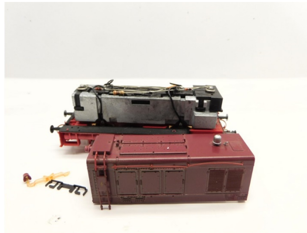
Gehäuse entfernen Remove housing Verwijder de kap
