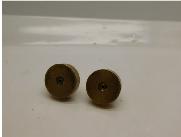
Platzieren Sie die Wellenadapter in die Schwungmassen Mount the shaft adapters in the flywheels Plaats de asadapters in de vliegwielen
