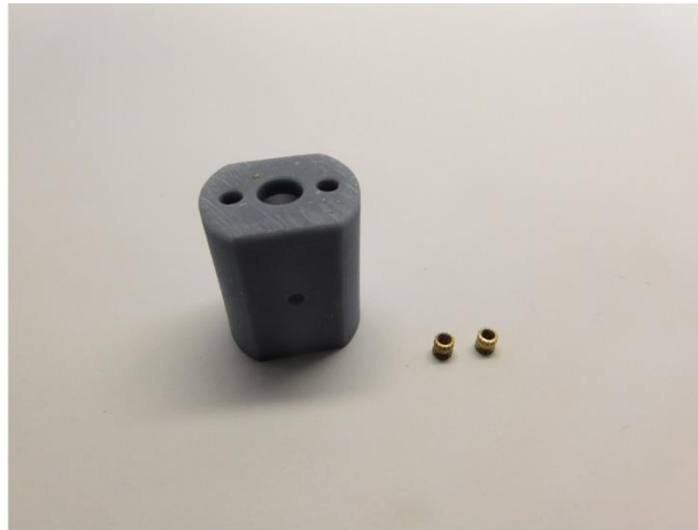
Die Messingeinsätze werden mit Sekundenkleber in den Motorhalter eingeklebt The brass inserts are glued into the motor holder with superglue De messing inserts worden met secondelijm verlijmd
