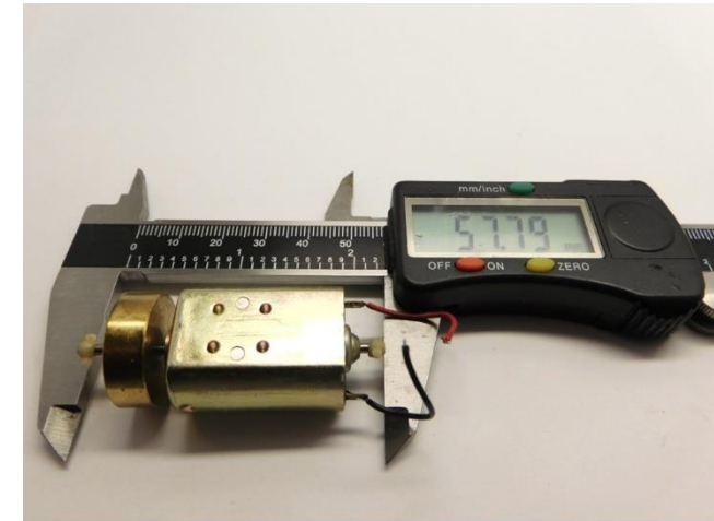
Maße prüfen Check dimensions Controleer de maatvoering
