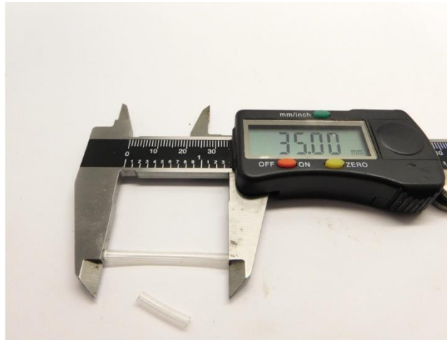
Kürzen Sie ein Stück Schlauchkupplung Shorten the piece of hose coupling Kort de slangkoppeling in
