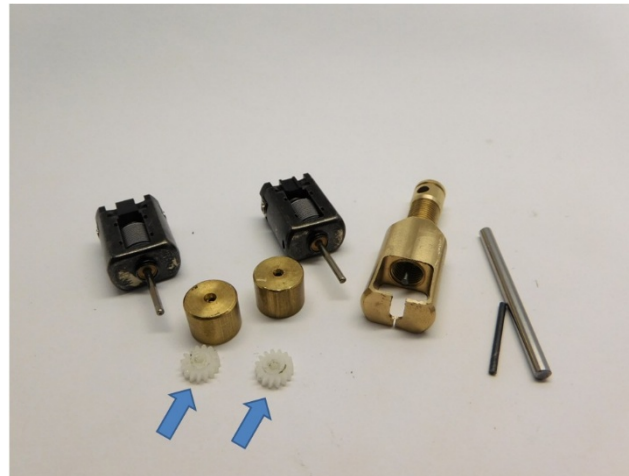
Sie brauchen die Teile wieder. Diese werden mit einer Ritzel Abzieher entfernt You need the parts again. They can be removed with a gear puller Je hebt de onderdelen wederom nodig. Ze worden met een wormwieltrekker verwijderd
