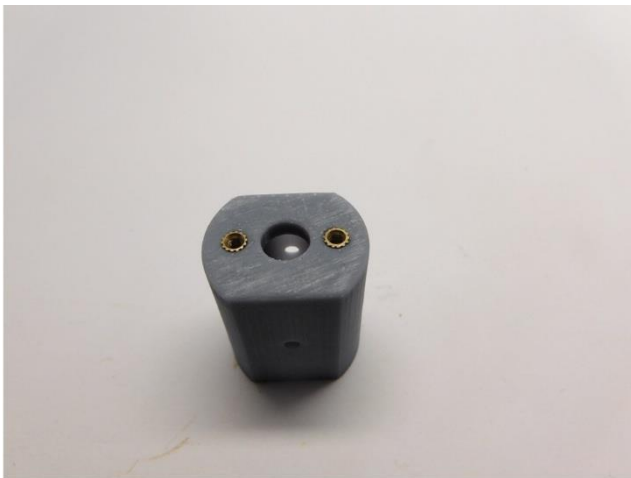
Die Messingeinsätze eingeklebt The brass inserts are glued De messing insert zijn verlijmd
