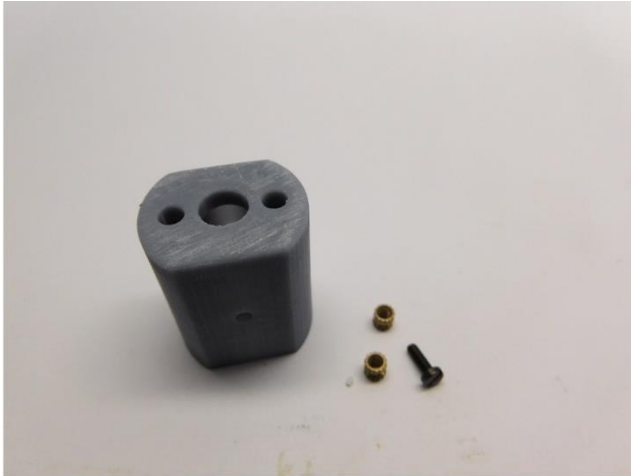
Die Messingeinsätze werden mit Sekundenkleber in den Motorhalter eingeklebt The brass inserts are glued into the motor holder with superglue De messing inserts worden in de motorhouder verlijmd met secondelijm
