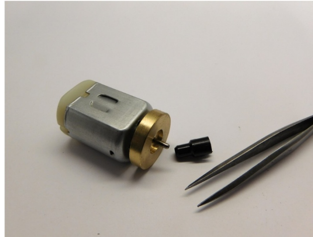
Sie brauchen dieses Teil wieder. Diese wird mit einer Pinzette entfernt You need the part again. It can be removed with tweezers U heeft het onderdeel weer nodig. Het wordt met een pincet verwijderd
