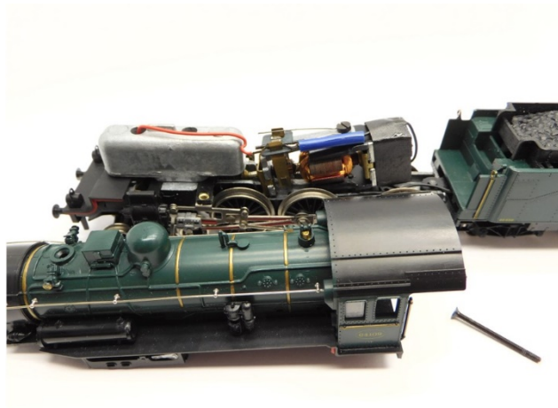
Gehäuse entfernen Remove housing Verwijder de kap
