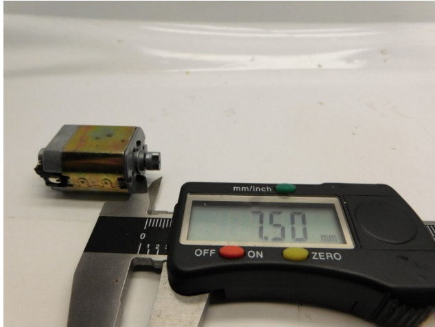
Maße prüfen Check dimensions Controleer de maatvoering
