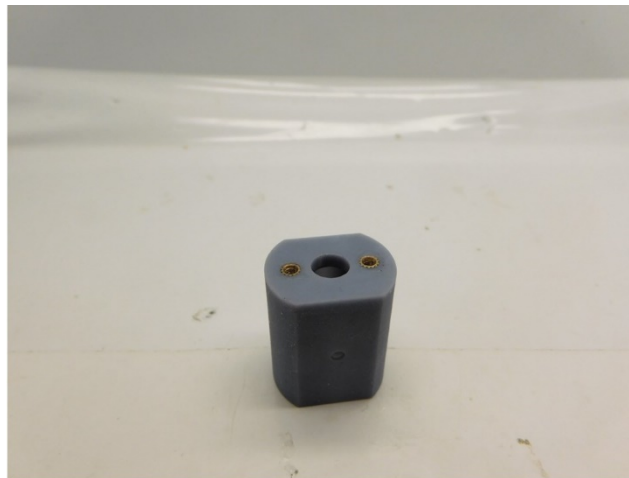
Die Messingeinsätze eingeklebt The brass inserts are glued De messing inserts zijn verlijmd
