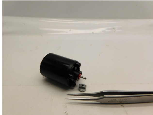
Sie brauchen dieses Teil wieder. Diese wird mit einer Pinzette entfernt You need the part again. It can be removed with tweezers Je hebt dit onderdeel wederom nodig. Het kan met een pincet verwijderd worden
