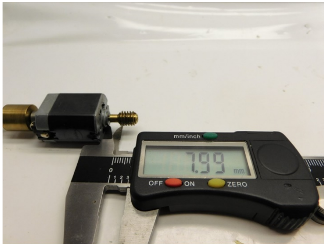
Maße prüfen Check dimensions Controleer de maatvoering
