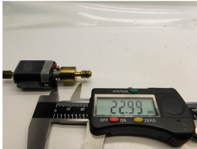
Maße prüfen Check dimensions Controleer de maatvoering
