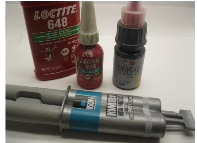
Metal Teile werden mit Loctite oder Metal Epoxy Kleber verklebt Metal parts are glued with Loctite or metal epoxy glue Metalen onderdelen worden gelijmd met metaallijm of epoxylijm voor metalen
