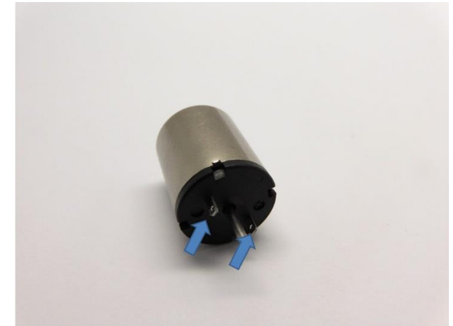
Biegen Sie die Motorkontakte Bend the motor contacts Buig de motorcontacten
