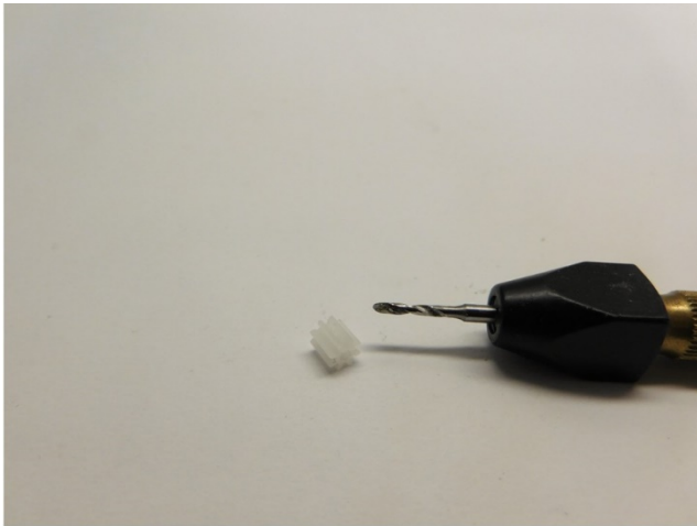
Loch räumen auf 1,5 mm Enlarge the hole to 1.5mm Ruim het gat naar 1.5 mm
