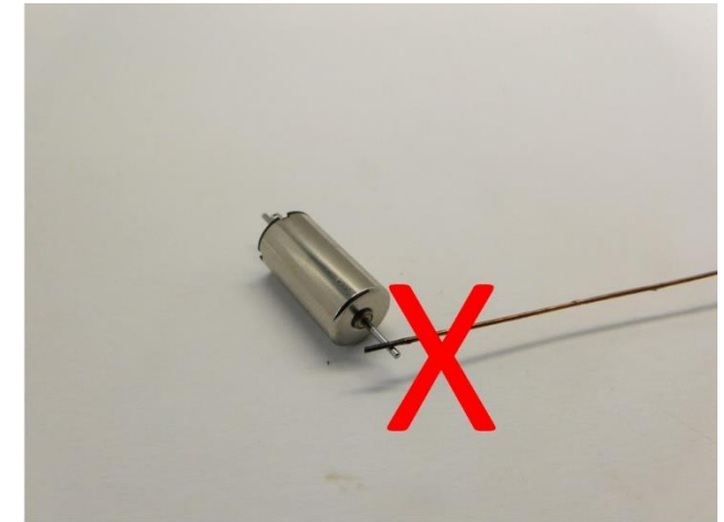
Tragen Sie keinen Kleber auf die Achse auf Don't apply glue on the axle Plaats geen lijm op de as
