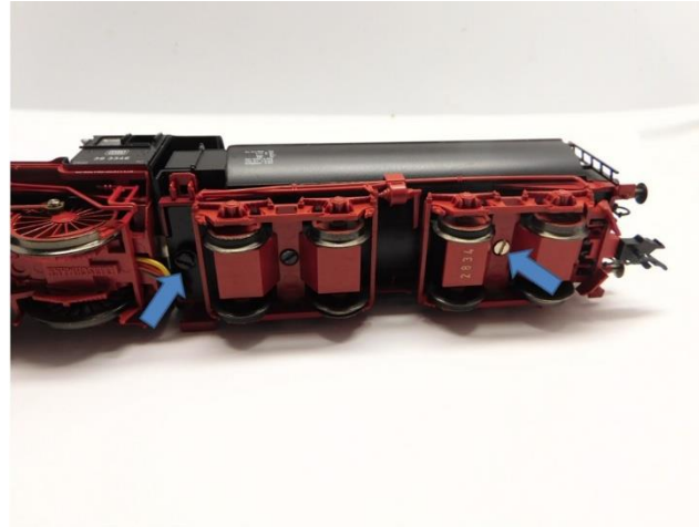
Gehäuse entfernen Remove housing Verwijder de kap
