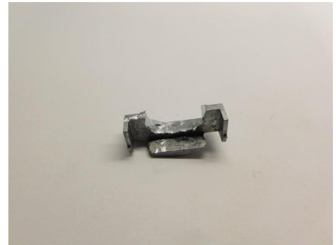
Platz Fräsen, damit der Motor passt Mill space so the motor fits
