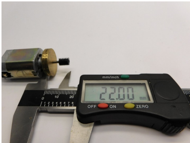
Maße prüfen Check dimensions Controleer de maatvoering
