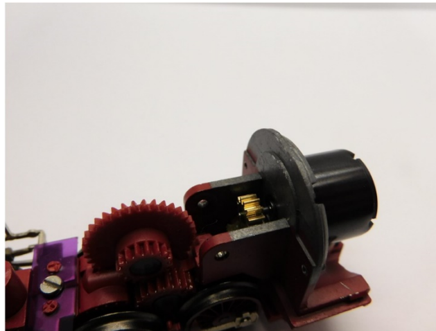
Platzieren Sie das Ritzel Mount the gear Plaats het tandwiel
