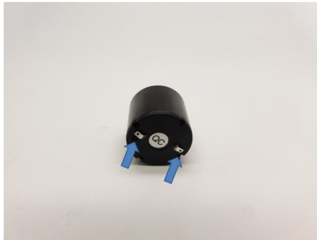
Biegen Sie die Motorkontakte Bend the motor contacts Buig de motor contacten
