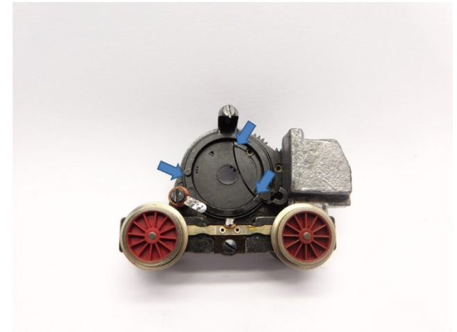
Motorhalter mit Metallkleber kleben Glue the motorholder with metal glue Verlijm de motorhouder met metaallijm
