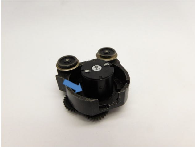
Motor mit Metallkleber kleben Glue the motor with metal glue Verlijm de motor met metaallijm
