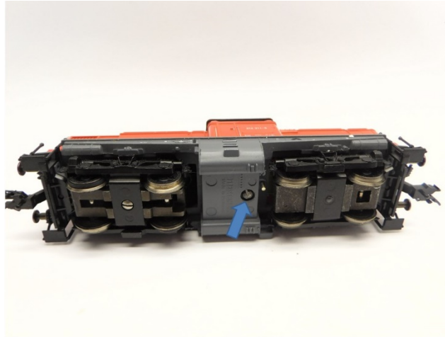
Gehäuse entfernen Remove housing Verwijder de kap
