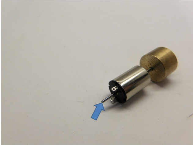
Motorwelle mit Trennscheibe kürzen Shorten the motor axle with a cutting disk Kort de as met een slijpschijf in
