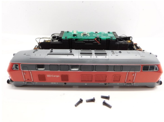
Gehäuse entfernen Remove housing Verwijder de kap
