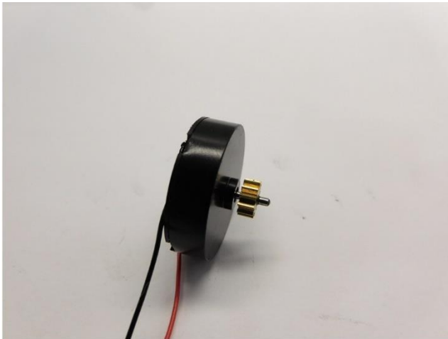
Die Teile sind verklebt und die Drähte verlötet The parts are glued and the wires are soldered De onderdelen zijn verlijmd en de draden zijn gesoldeerd
