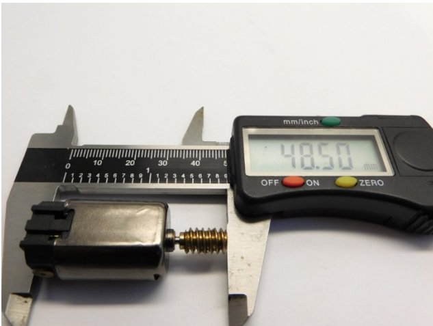
Maße prüfen Check dimensions Controleer de maatvoering
