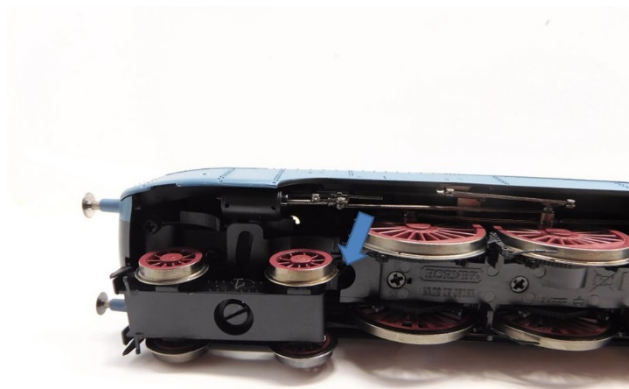
Gehäuse entfernen Remove housing Verwijder de kap
