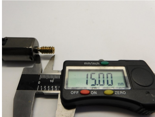
Maße prüfen Check dimensions Controleer de maatvoering
