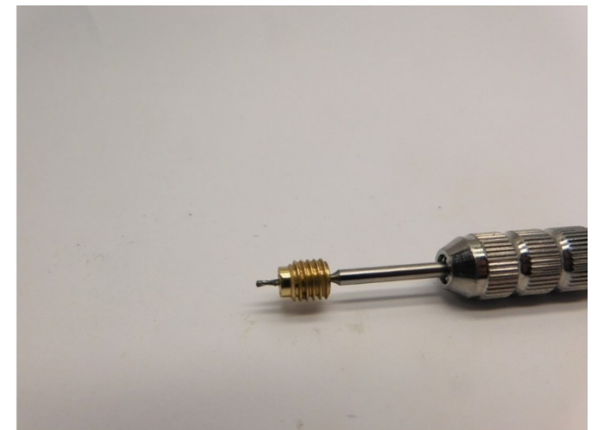
Prüfen Sie ob das Loch 1 mm groß ist Check that the hole is 1mm Controleer of het gat 1 mm is
