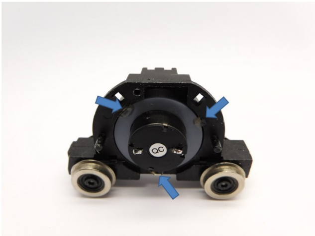
Der Motorhalter ist mit Heißkleber verklebt The motor holder is glued with hotmelt De motorhouder wordt met smeltlijm verlijmd
