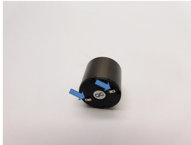
Biegen Sie die Motorkontakte Bend the motor contacts Buig de contacten
