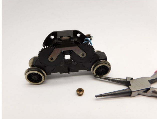
Ausbau Lager Take out bearing Verwijder het lager
