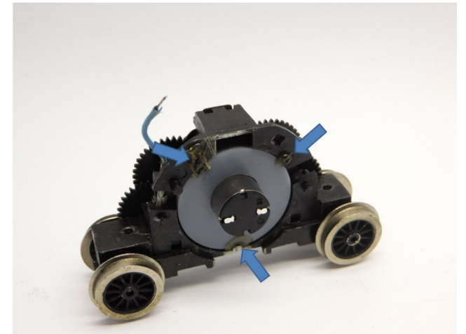
Der Motorhalter ist mit Heißkleber verklebt The motor holder is glued with hotmelt De motorhouder wordt met smeltlijm verlijmd
