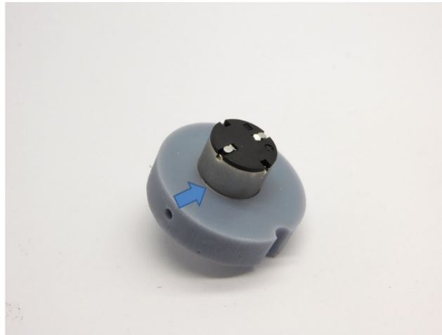
Der Motor wird mit Epoxidkleber oder Sekundenkleber in den Motorhalter eingeklebt The motor is glued into the motor holder with epoxy glue or super Glue De motor wordt in de motorhouder verlijmd met secundelijm of epoxy lijm
