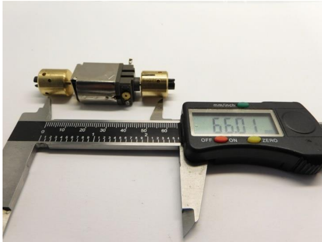
Maße prüfen Check dimensions Controleer de maatvoering
