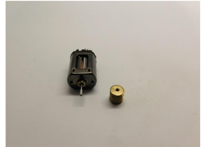
Sie brauchen dieses Teil wieder. Diese wird mit einem Ritzelabzieher entfernt You need the part again. It can be removed with a gear puller Je hebt dit onderdeel wederom nodig. Het wordt met een tandwieltrekker verwijderd
