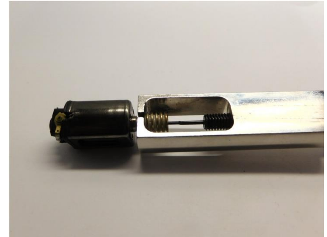
Sie brauchen dieses Teil wieder. Diese wird mit einem Ritzelabzieher entfernt You need the part again. It can be removed with a gear puller Je hebt dit onderdeel wederom nodig. Het wordt met een tandwieltrekker verwijderd
