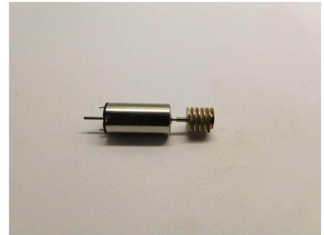
Die Teile sind verklebt The parts are glued De onderdelen zijn verlijmd
