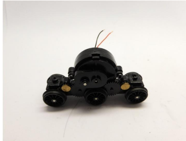
Zahnräder montieren Mount gears Plaats de tandwielen
