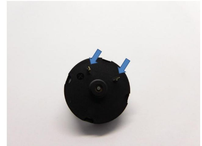
Biegen Sie die Motorkontakte Bend the motor contacts Buig de contacten
